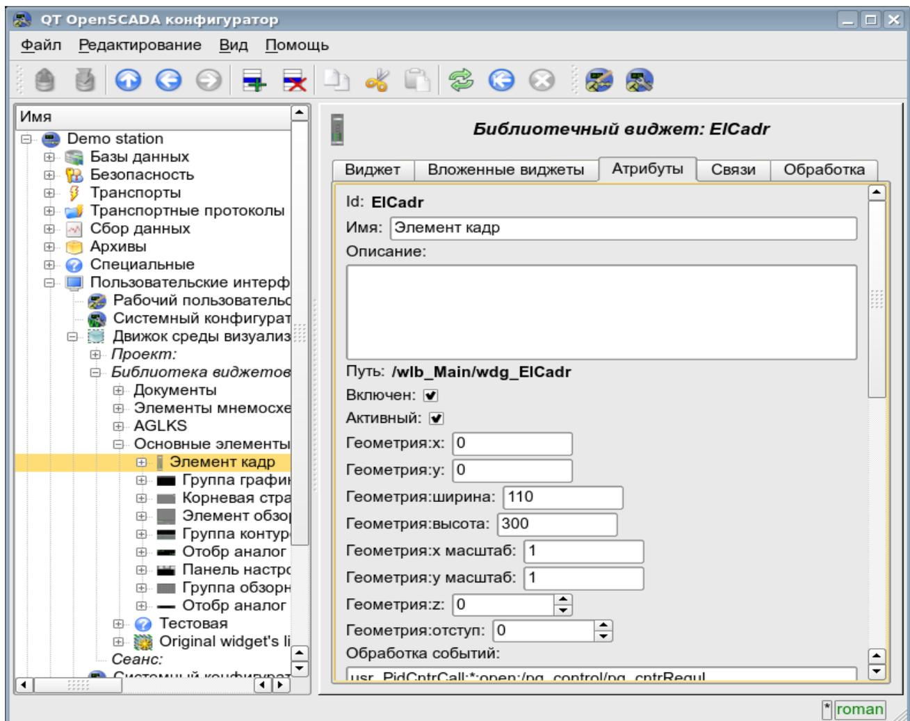
Рис.4.8 Вкладка атрибутов визуальных элементов.
