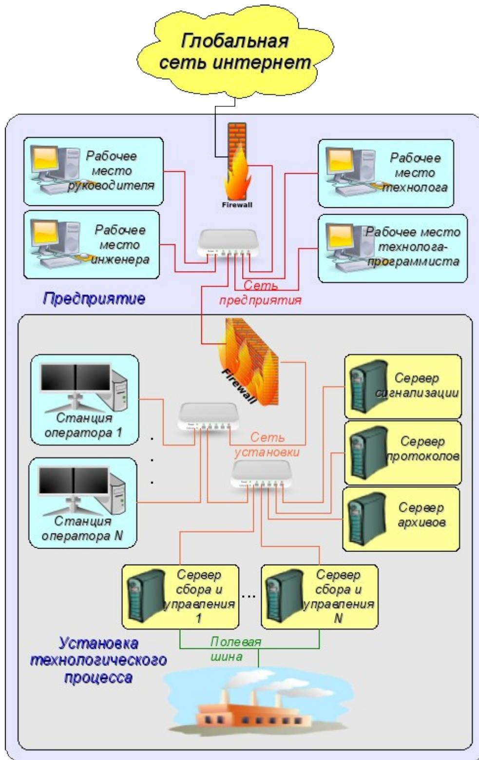
Рис. 2. SCADA-система.
