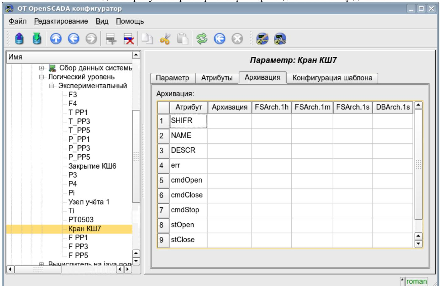
Рис. 42. Вкладка 'Архивация' параметра контроллера подсистемы 'Сбор данных'.
