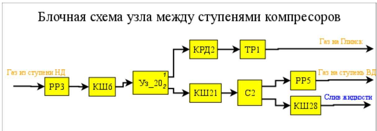
Рис. 1. Общие связи между блоками блочной схемы
