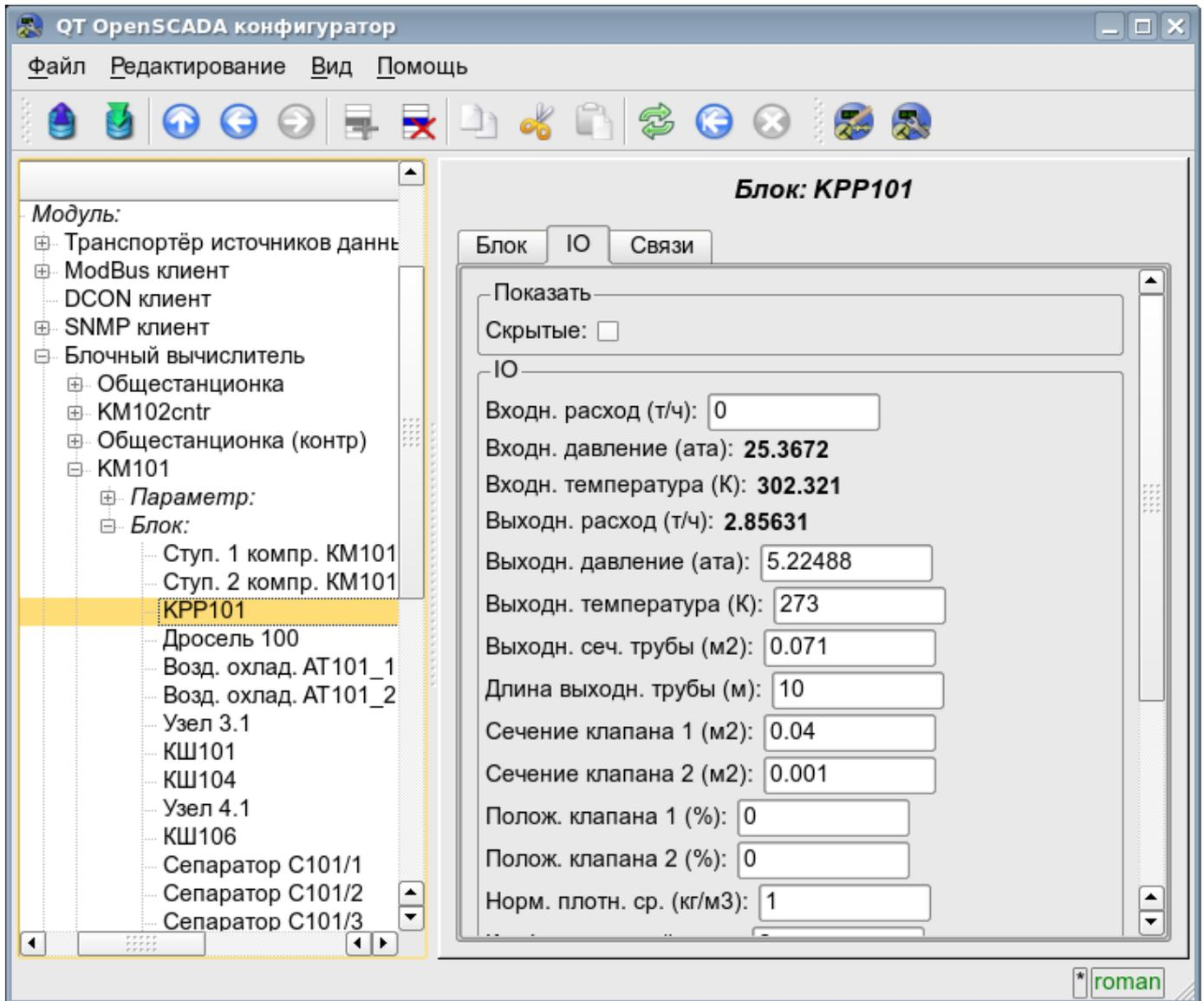
Рис. 6. Вкладка конфигурации значений параметров блока блочной схемы.
