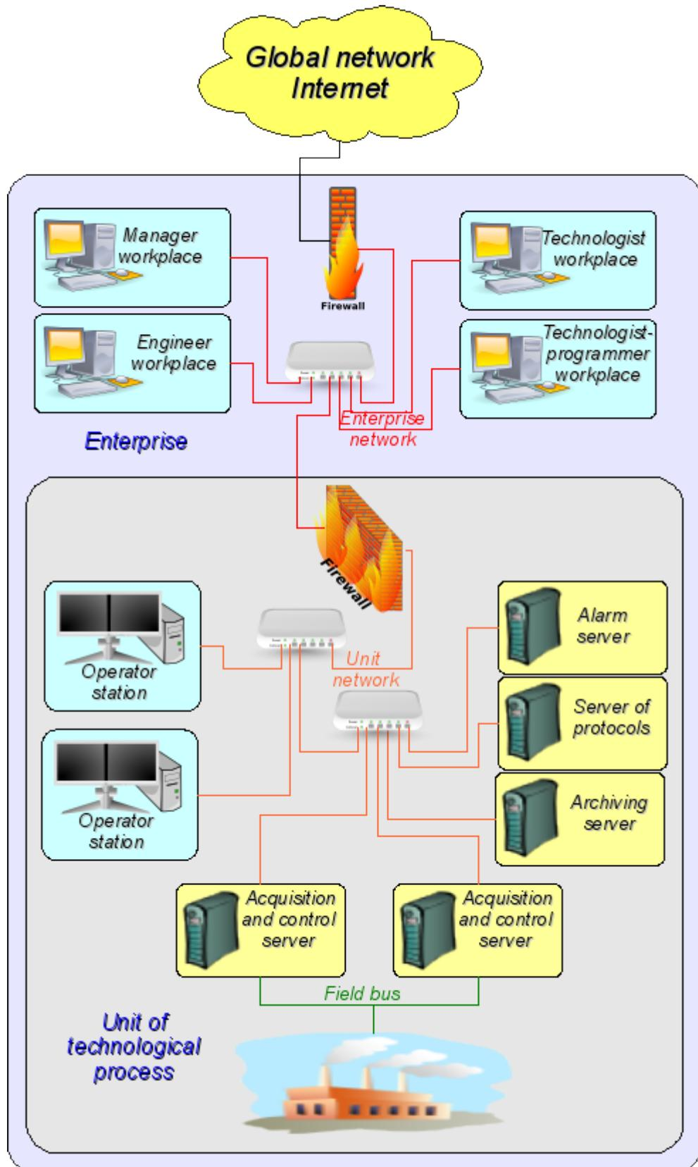
Рис. 2. SCADA-system.
