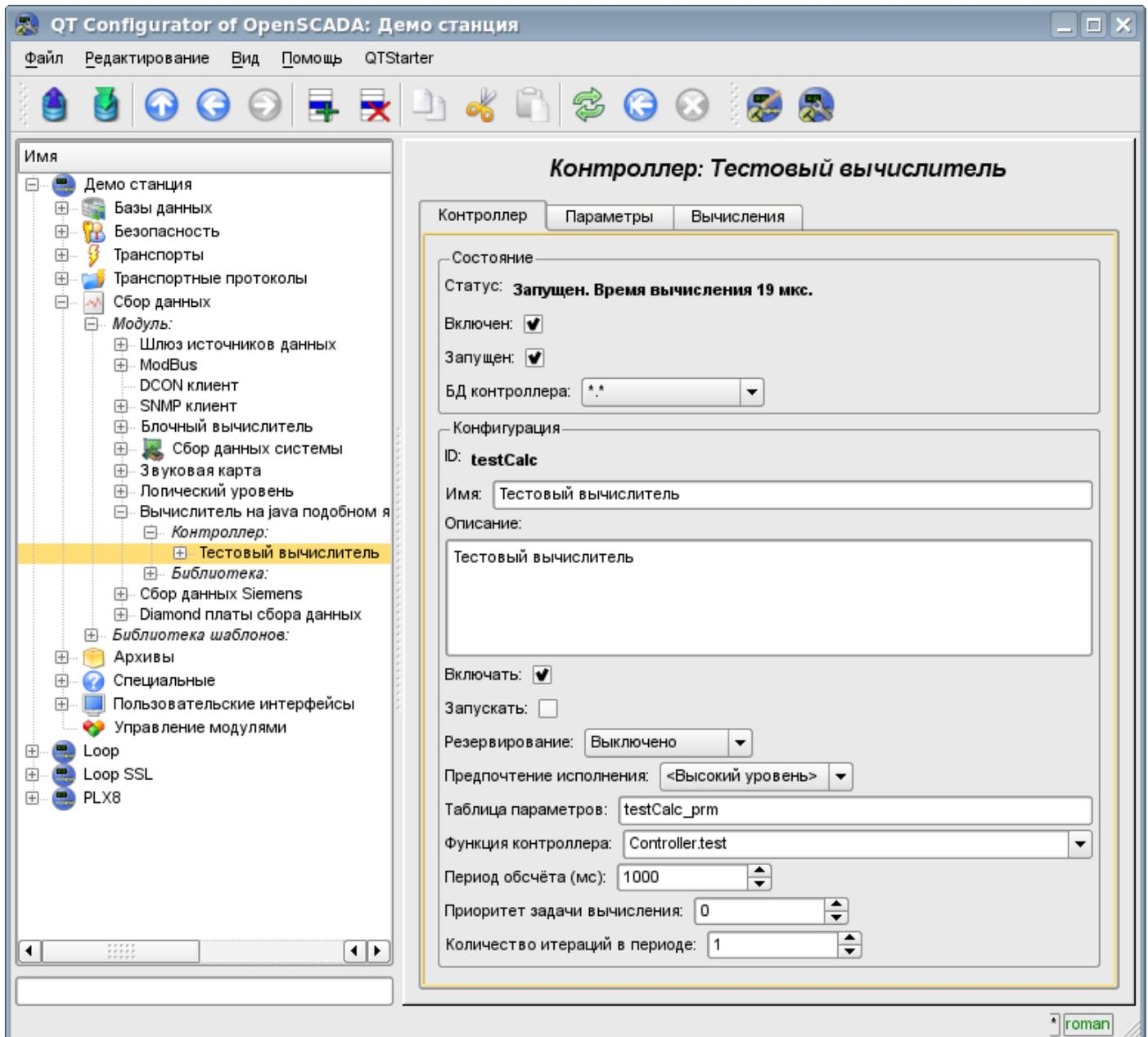
Рис.2. Вкладка конфигурации контроллера.
