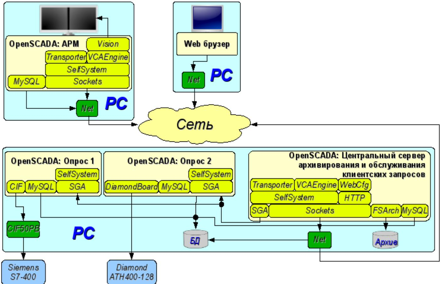
Рис. 10. Устойчивая, распределённая конфигурация
