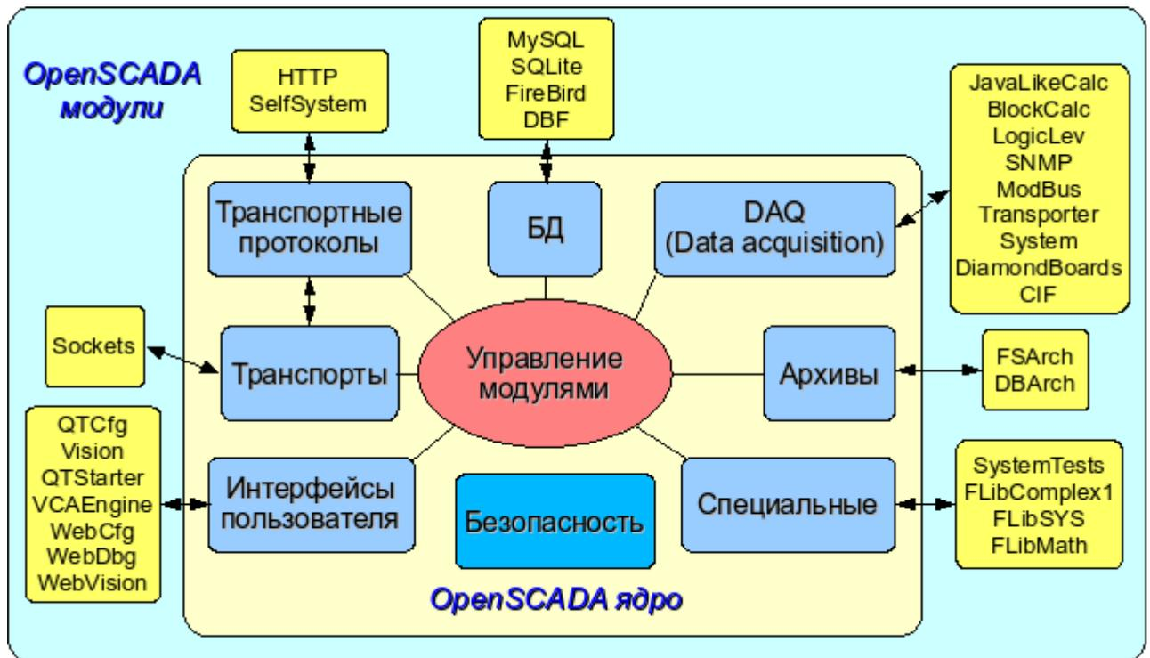
Рис. 1. Блочная схема системы OpenSCADA
