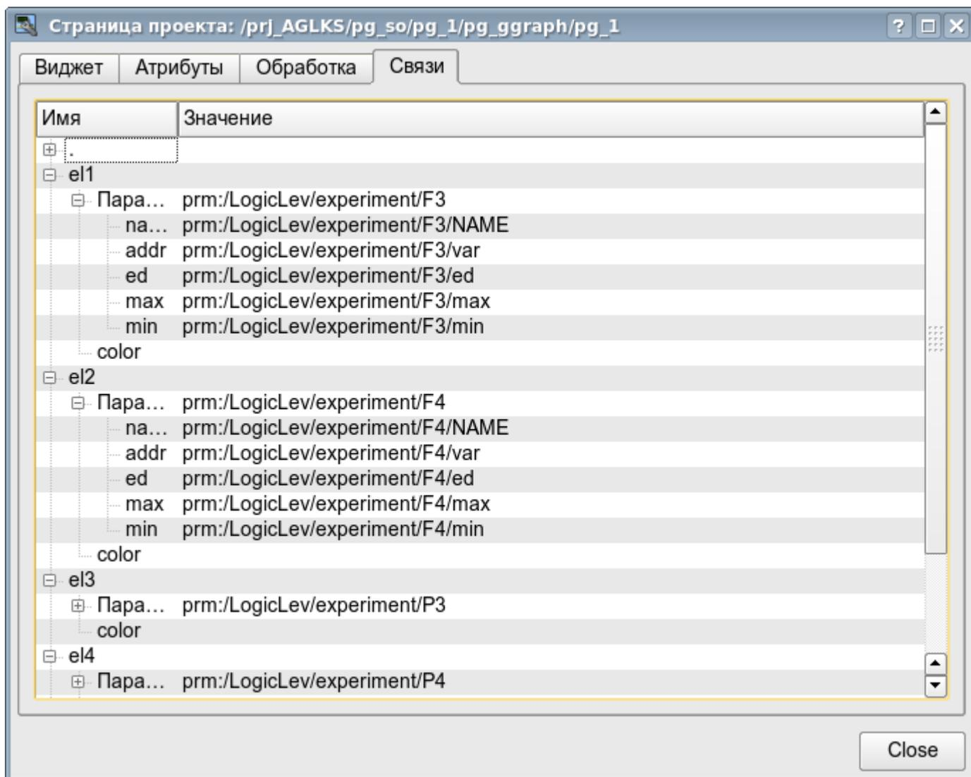
Рис.7. Вкладка связей диалога редактирования свойств визуального элемента.
