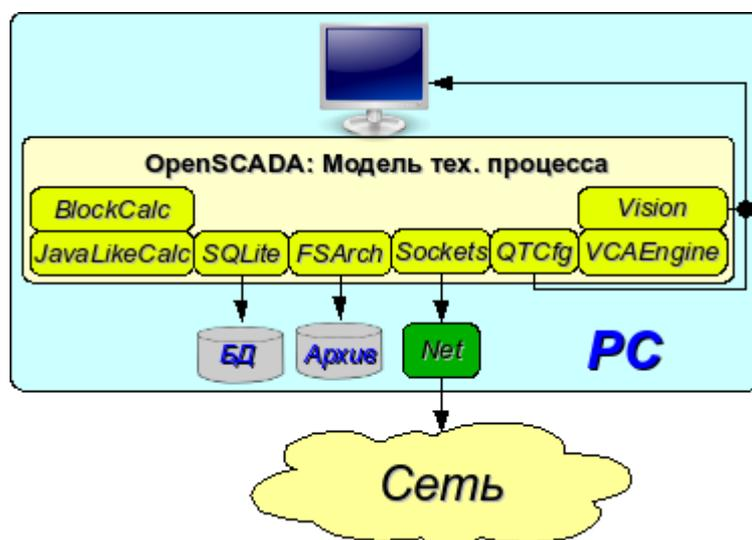
Рис. 9. Простейшее смешанное подключение (модель, демонстрация, конфигуратор ...)
