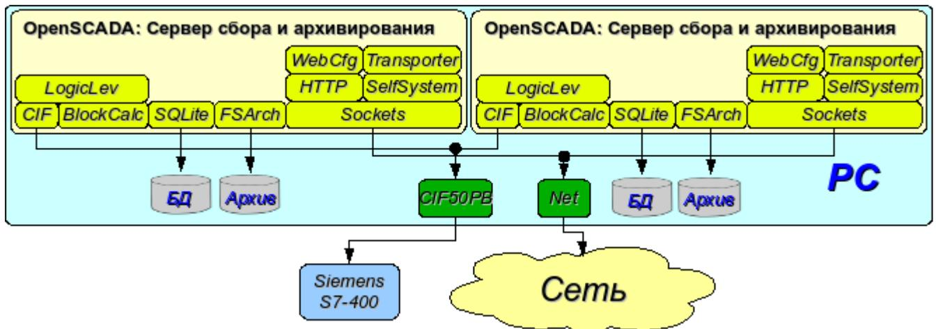
Рис. 5. Дублированное серверное подключение на одном сервере.
