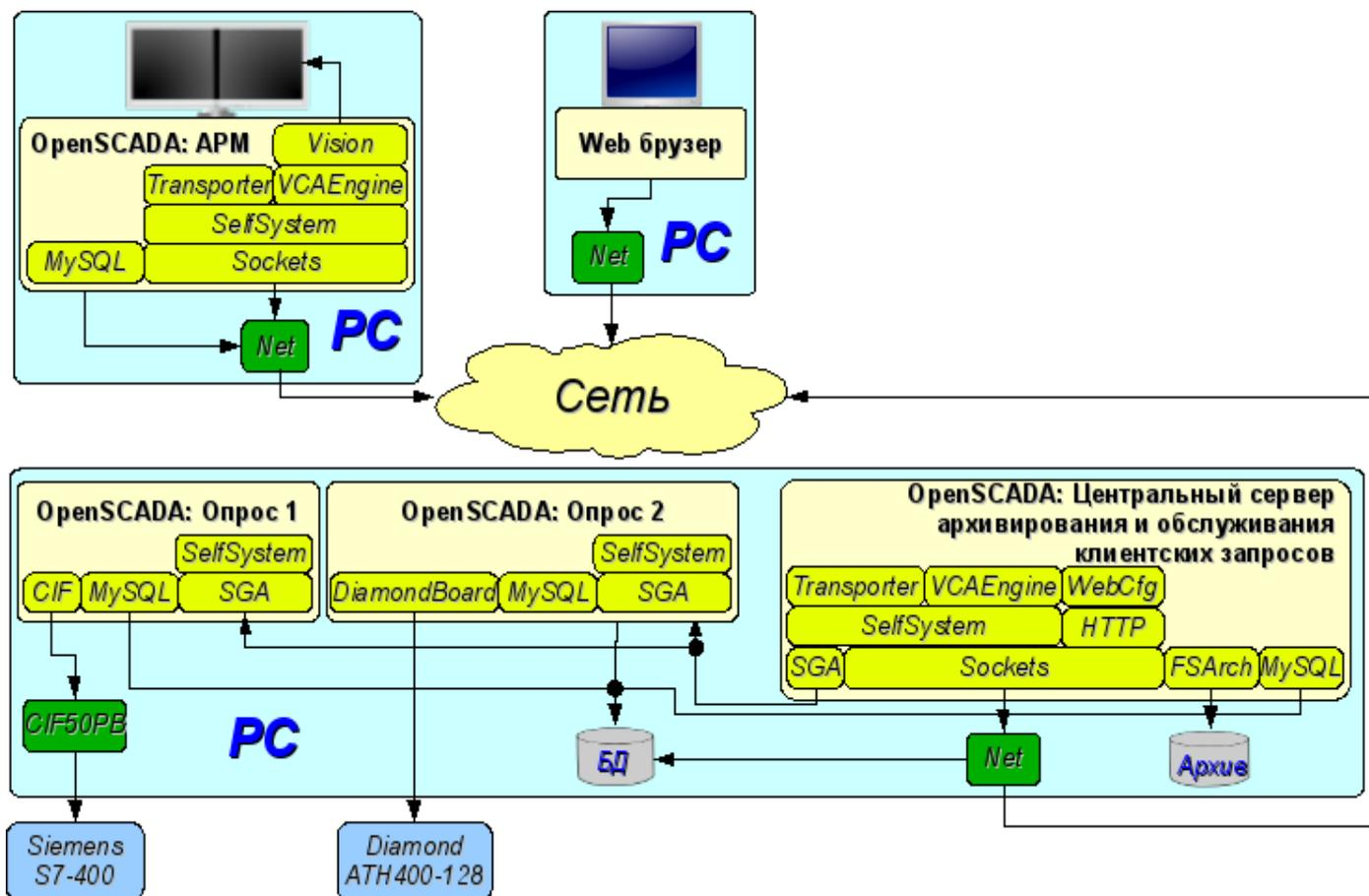
Рис. 10. Устойчивая, распределённая конфигурация
